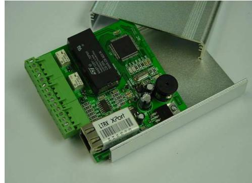
SDC 6K-L 控制器是設計用以提供控制器正處於脫機狀態時，作更多更高效能的運作。包括：電梯控制、本地防止重複進入及報警連動輸出。另外，當 SDC 6K-L 控制器需用於較高層次的保安應用時，亦有能力進行熱轉換的通訊。
